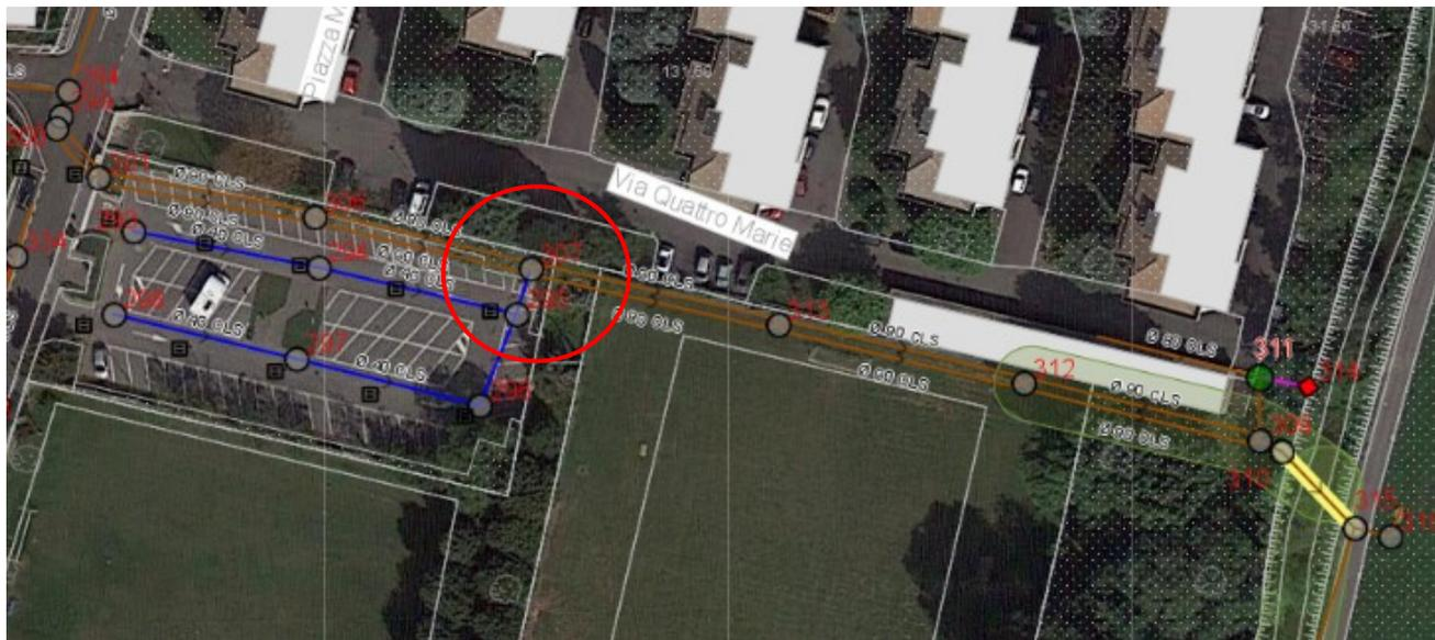
Fig. 2.8 – Area prescelta per la disconnessione della rete meteorica di Via Quattro Marie
