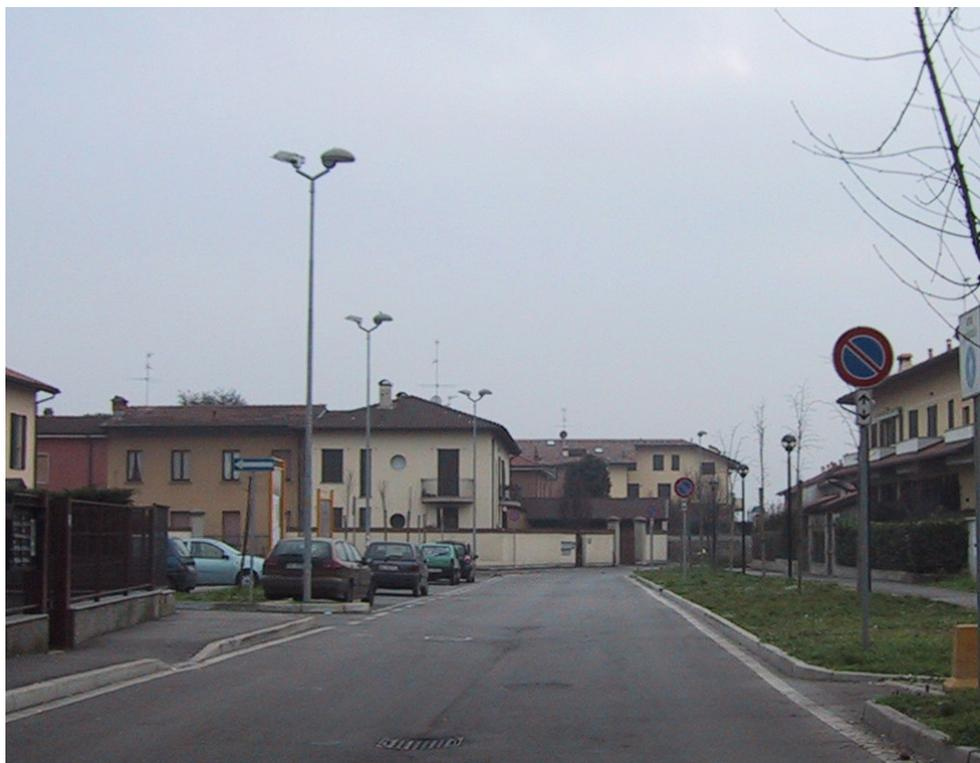
Via Marconi: apparecchi stradali e proiettori totalmente schermati, installati su pali, per l'illuminazione della sede viaria e del parcheggio e globi a norma di L.R. 17/00 e L.R. 38/04 dislocati lungo il percorso pedonale.
