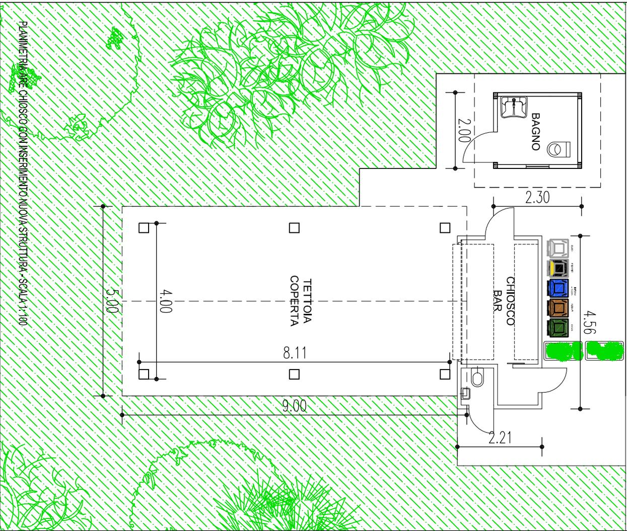
PLANIMETRIA ARE CHIOSCO CON INSERIMENTO NUOVA STRUTTURA - SCALA 1:100
